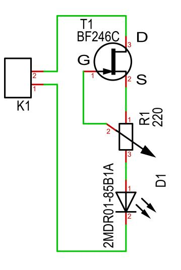
Der BF 246C ist ein JFET kein isoliertes Gate sondern PN Übergang Außerdem ist er selbstleitend, heißt, er leitet ohne Gatespannung und sperrt erst, wenn Gate gegenüber Source negativ wird
